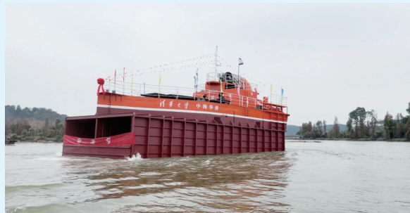
中国首台超100千瓦气动式海浪发电装备在江门新会下水。黄胜 摄
